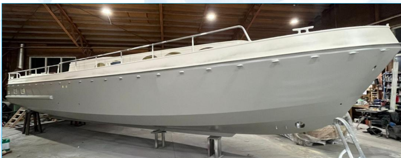
Het casco van een '47' na het stralen en conserveren.
