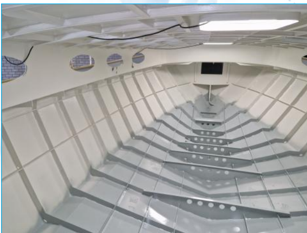
In de kajuit van een '36' is grijze industriële lak gespoten tot vloerhoogte.
