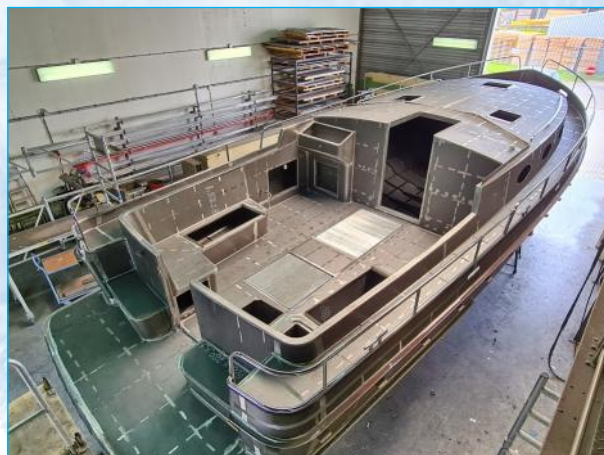
Het casco van een '33' klaar om te worden gestraald.
